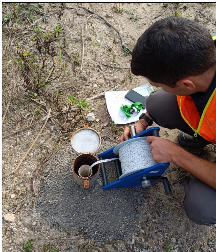
Figura 2: Aferição do Nível freático em piezómetro
